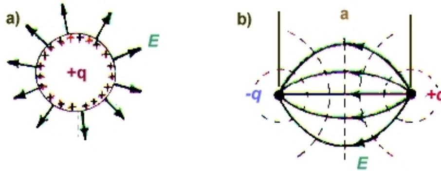
**Abbildung 1.8.** Elektrische Feldverteilungen: a) ein elektrischer Monopol [punktförmige oder kugelförmige Einzelladung]. Sein elektrisches Feld (Coulombfeld) zeigt radial vom Mittelpunkt nach außen und nimmt wie  $1/(\text{Abstand})^2$  ab. b) Der elektrische Dipol [zwei entgegengesetzte Ladungen im festen Abstand  $a$ ]. Sein Feld ist gekrümmt und zeigt eine Symmetrieebene (gestrichelt).
