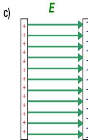
**Abbildung 1.9.** c) Das homogene Feld zwischen den Platten eines geladenen Plattenkondensators; es hat überall die gleiche Stärke und Richtung.
