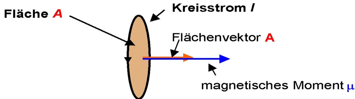
Abbildung 1.18. Magnetisches Moment als Kreisstrom.
