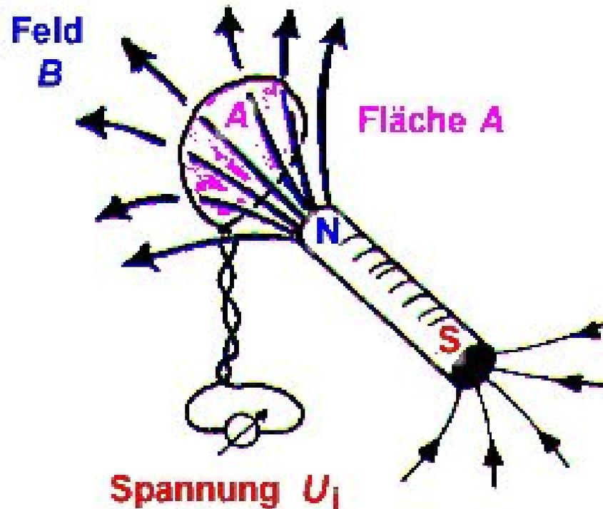
**Abbildung 1.22.** Drahtschleife im  $B$ -Feld eines Stabmagneten. Bewegung oder Drehung der Schleife induziert die Spannung  $U_i$  in der Schleife, nach dem Faraday'schen Induktionsgesetz
