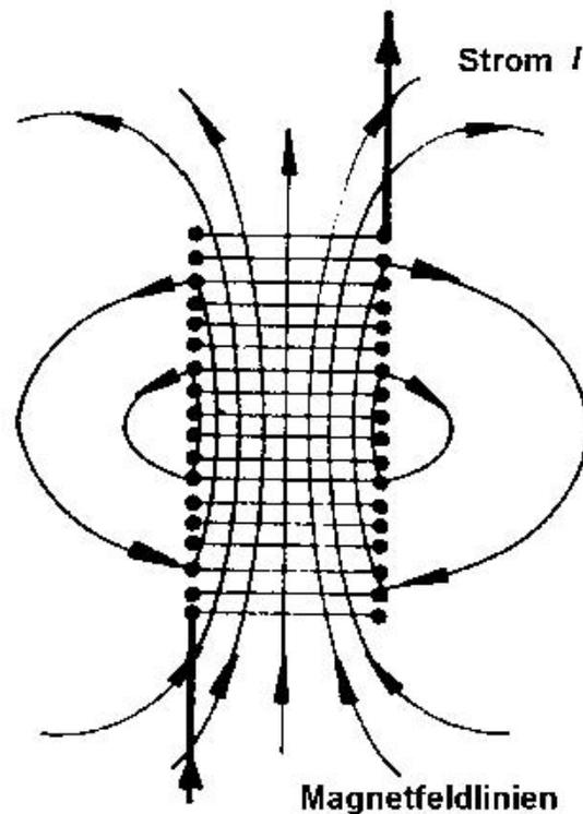
**Abbildung 1.19.** Stromführende Spule im Querschnitt. Das Magnetfeld  $H$  innerhalb der Spule ist nahezu homogen (überall gleiche Stärke und Richtung)
