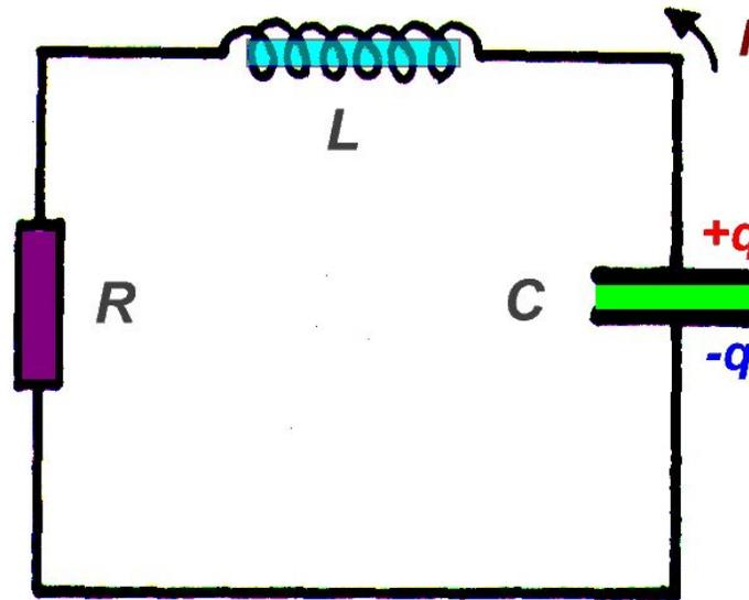
**Abbildung 1.26.** Elektrischer Schwingkreis ( $LRC$ -Kreis). Der Kondensator speichert elektrische Energie in seinem elektrischen Feld, die Spule speichert magnetische Energie in ihrem Magnetfeld. Die Schwingungsenergie wechselt zwischen diesen beiden Formen, wie in einem mechanischen Oszillator zwischen potentieller und kinetischer Energie. Der Widerstand wandelt Schwingungsenergie in Wärme um und bewirkt damit eine Dämpfung der Schwingungen.
