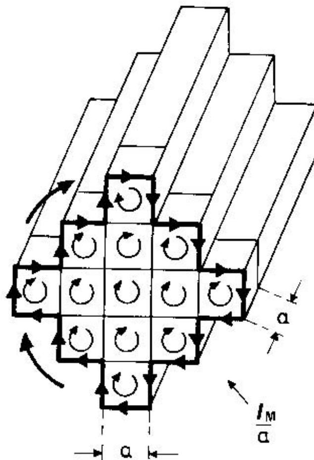
**Abbildung 1.20.** Schematische Darstellung von Materie in einem Magnetfeld. Atomare Dipole sind durch kleine Kreisströme symbolisiert; der Abstand der Atome ist gegeben durch die Gitterkonstante  $a$ . Sie fügen sich an den Enden des Materiestücks zu einem gesamten Flächenstrom  $I_M$  zusammen. Außerhalb der Materie entsteht durch die gerichtete Dipole ein äußeres Magnetfeld (gekrümmte Pfeile)
