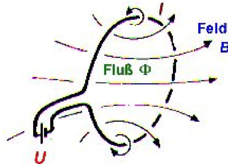
**Abbildung 1.25.** Drahtschleife mit einer externen Spannungsquelle. Der Strom  $I$  im Draht erzeugt das magnetische Induktionsfeld  $B$  und somit den Fluß  $\Phi = BA$  ( $A =$  Fläche der Schleife). Ändert sich die Spannung  $U$  zeitlich (z.B.  $U(t) = U_0 \sin[\omega t + \varphi]$ ), so werden  $B$  und  $\Phi$  auch zeitlich verändert, eine Induktionsspannung  $U_i = -d\Phi/dt$  erscheint zwischen den Enden der Drahtschleife [entgegengesetzt zur momentanen externen Spannung  $U(t)$ ]
