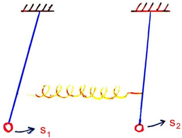
Abbildung 0.15. Zwei mit einer Feder gekoppelte Fadenpendel
