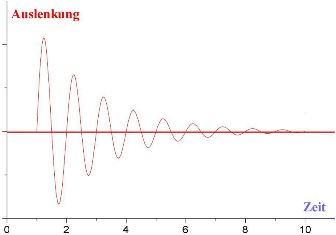
Abbildung 0.12. gedämpfte Schwingung
