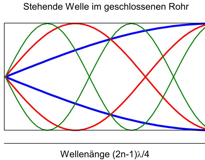
**Abbildung 0.19.** Stehenden Welle im einseitig geschlossenen Rohr
