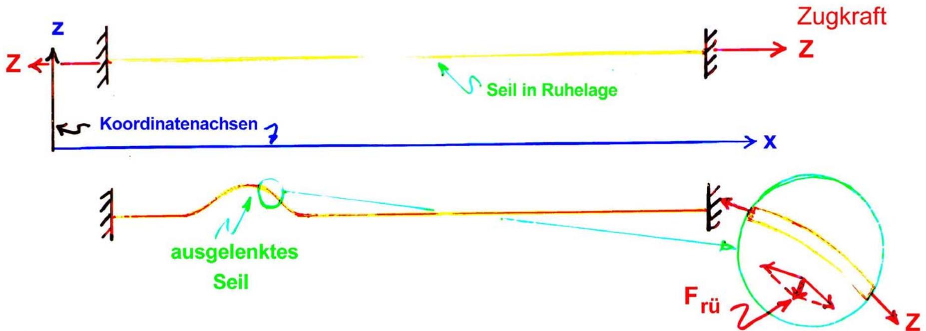
Abbildung 0.17. Die Welle am Beispiel der Seilwelle
