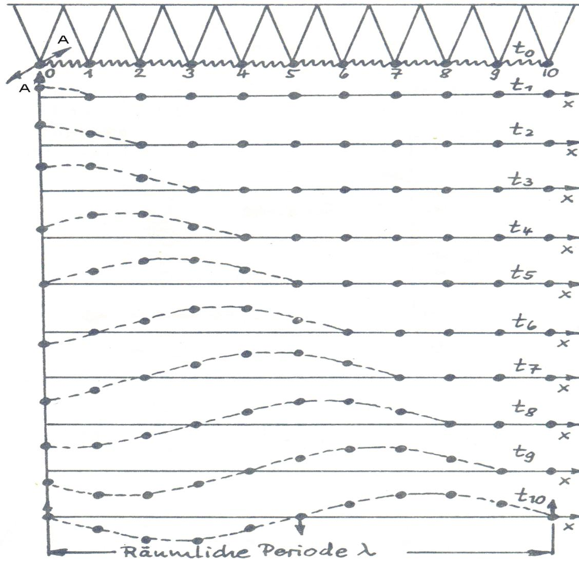
Abbildung 0.16. Mechanische Wellen
