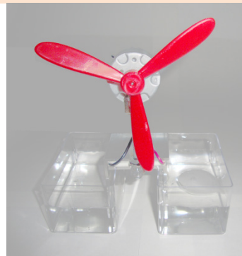
Abb.: Thermogenerator mit kochendem und Eiswasser.
