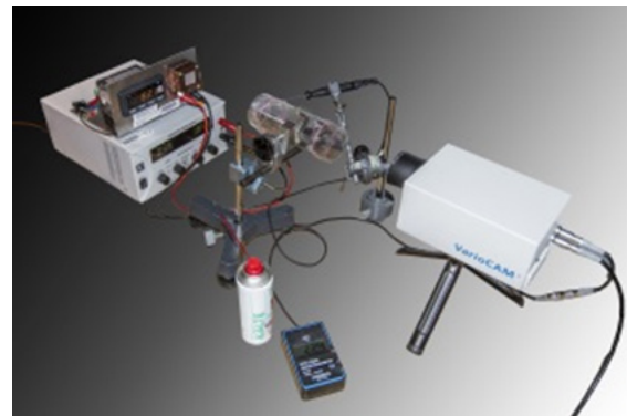
Abb.: Messaufbau Thermokamera mit Küvette und Temperaturquelle.
