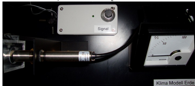
Abb.: Messwerteinstellung über das Potentiometer „Signal“.
