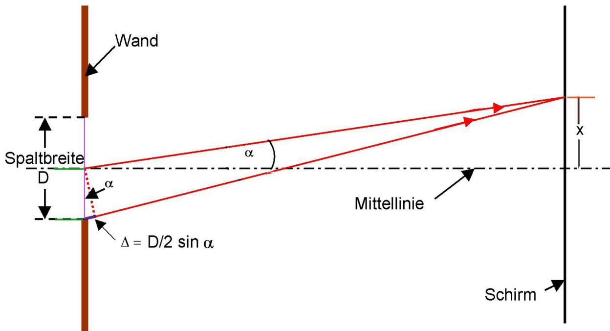
**Gangunterschied von zwei Elementarwellen:** zwei Strahlen, die um einen Winkel  $\alpha$  an einem Spalt der Breite  $D$  abgelenkt werden und sich auf einem (weit entfernten) Schirm am Ort  $x$  von der Mittellinie entfernt treffen, haben einen **Gangunterschied**  $\Delta$ ; er beträgt hier  $D/2 \sin \alpha$  (ähnliche Dreiecke).
