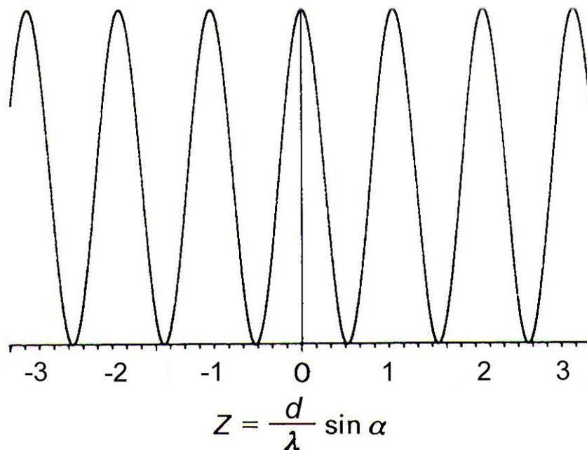
Die Verteilung der Amplituden in der Beobachtungsebene ist **kosinusförmig**; die **Maxima** sind gegeben durch die Bedingung
