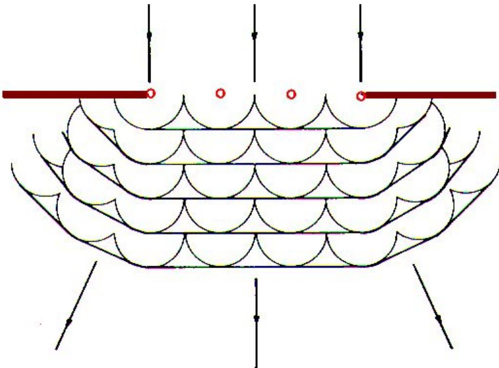
**Huygens'sche Konstruktion:** die von oben ankommende Lichtstrahlen lassen sich durch **Elementarquellen** (o) darstellen; jede Elementarquelle sendet eine Kugelwelle aus, die Überlagerung dieser Kugelwellen bildet die neue Wellen-front. Am Rand des Hindernisses werden die Wellen abgelenkt (Beugung).
