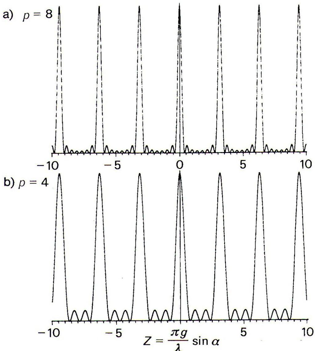
**Beugung am Gitter**, dargestellt für zwei verschiedene Gitter; *oben (a)* für 8 Einzelspalte, *unten (b)* für 4 Spalte. Es bilden sich *Hauptmaxima* aus, die restlichen Maxima im Interferenzbild werden mit wachsendem  $p$  zunehmend schwächer. Bei  $p = 4$  ist jedes 3. Maximum ein Hauptmaximum, bei  $p = 8$  jedes 7. Maximum usw.
