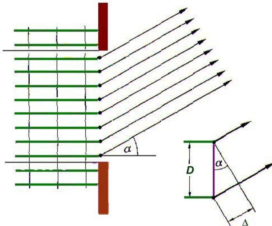
**Durch den breiten Spalt** laufen viele Parallelstrahlen, die alle um den Winkel  $\alpha$  abgelenkt werden; das kleine Bild zeigt den Gangunterschied  $\Delta = D \sin \alpha$  zwischen den **Randstrahlen**. Die Strahlen (jeder stellt eine Elementarwelle dar) treffen sich am Bildschirm und erzeugen dort Interferenzen.
