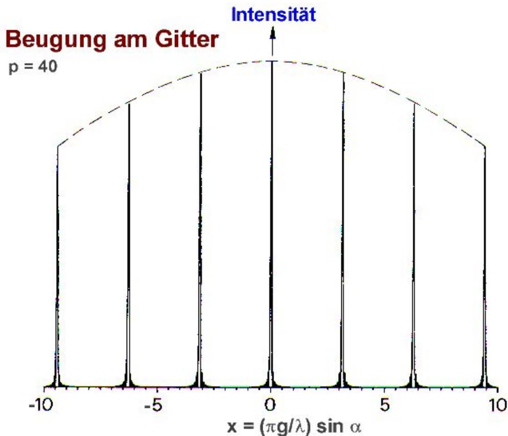
**Gitterbeugung** von einer großen Anzahl von Einzelspalten ( $p = 40$ ). Die Hauptmaxima sind nun sehr scharf und intensiv, die Nebenmaxima fast unsichtbar. Die einhüllende Kurve (gestrichelt) entspricht dem Beugungsbild der einzelnen Spalte.
