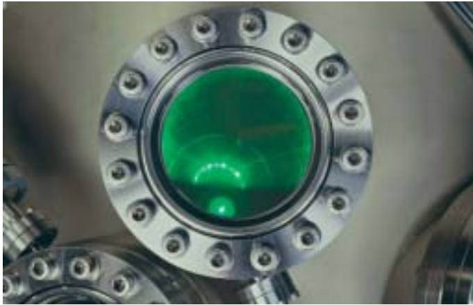
Elektronenbeugungsbild einer Silizium-Einkristalloberfläche. Die regelmäßige Anordnung der Atome an der Oberfläche führt zu Punkten und Kreisen auf dem Sichtschirm.
