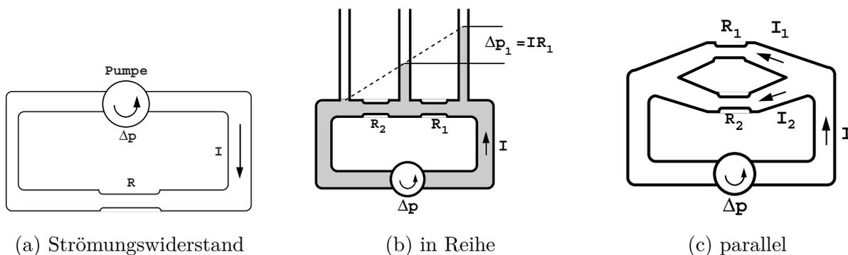
Abbildung 9: Verschiedene Anordnungen von Strömungswiderständen.
