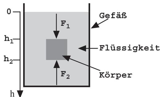
Abbildung 3: Körper in Flüssigkeit.
