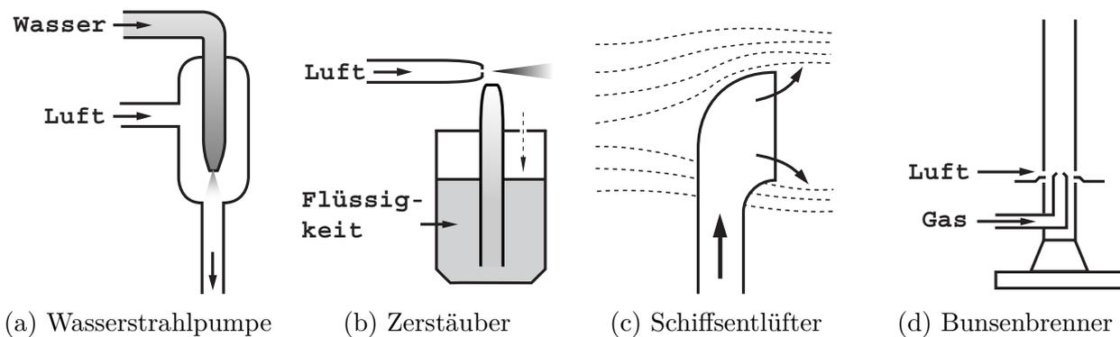
Abbildung 6: Darstellung einiger Anwendungen der Bernoullischen Gleichung.
