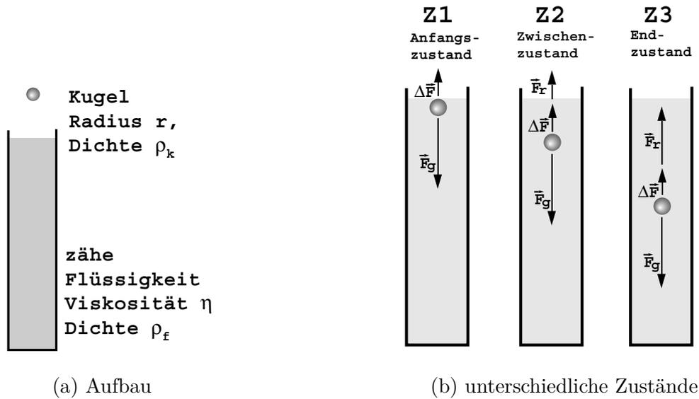
Abbildung 8: Kugelfallviskosimeter
