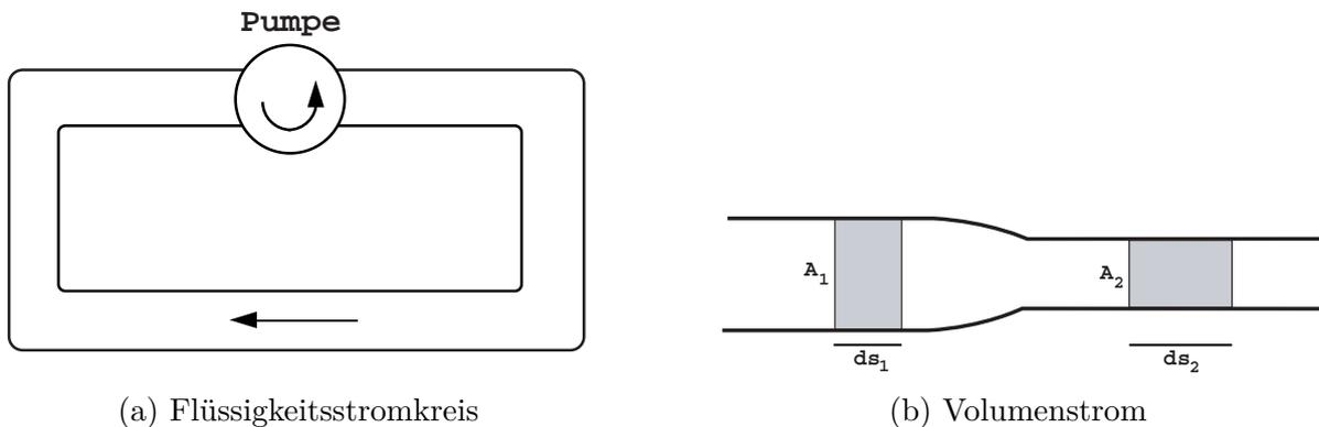
Abbildung 4: Veranschaulichung des Volumenstroms und der Volumenstromstärke.
