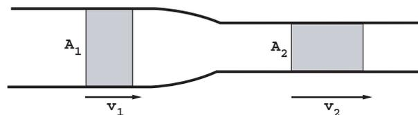
Abbildung 5: Ein Zuwachs an kinetischer Energie ist begleitet von einer betragsgleichen Abnahme an potentieller Energie (Energieerhaltung).
