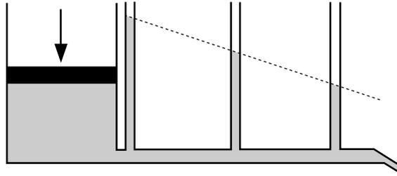
Abbildung 7: Durch einen Kolben erzeugter Druck.
