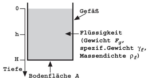
Abbildung 2: Gefäß mit Flüssigkeit.
