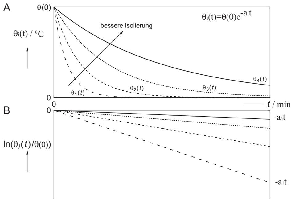
Abbildung T1.1: (A) Graphische Darstellung der Exponentialfunktion  $\theta_i(t) = \theta(0) \cdot e^{-a_i \cdot t}$  für vier verschiedene Werte  $a_1 > a_2 > a_3 > a_4$ . (B) Auftragung der Funktionen  $\ln(\theta_i(t)/\theta(0))$  gegen die Zeit  $t$ .
