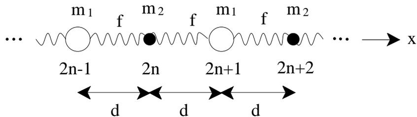
Die Massen  $m_1$  und  $m_2$ , die sich in  $x$ -Richtung abwechseln und mit ungeraden bzw. geraden Nummern gekennzeichnet sind, liegen auf einem Gitter der Gitterkonstante  $d$  und sind durch Federn der Federkonstante  $f$  gekoppelt. Es werden nun Schwingungen der Massen  $m_n$  in  $x$ -Richtung betrachtet, die durch die Auslenkungen  $u_n$  beschrieben werden.
