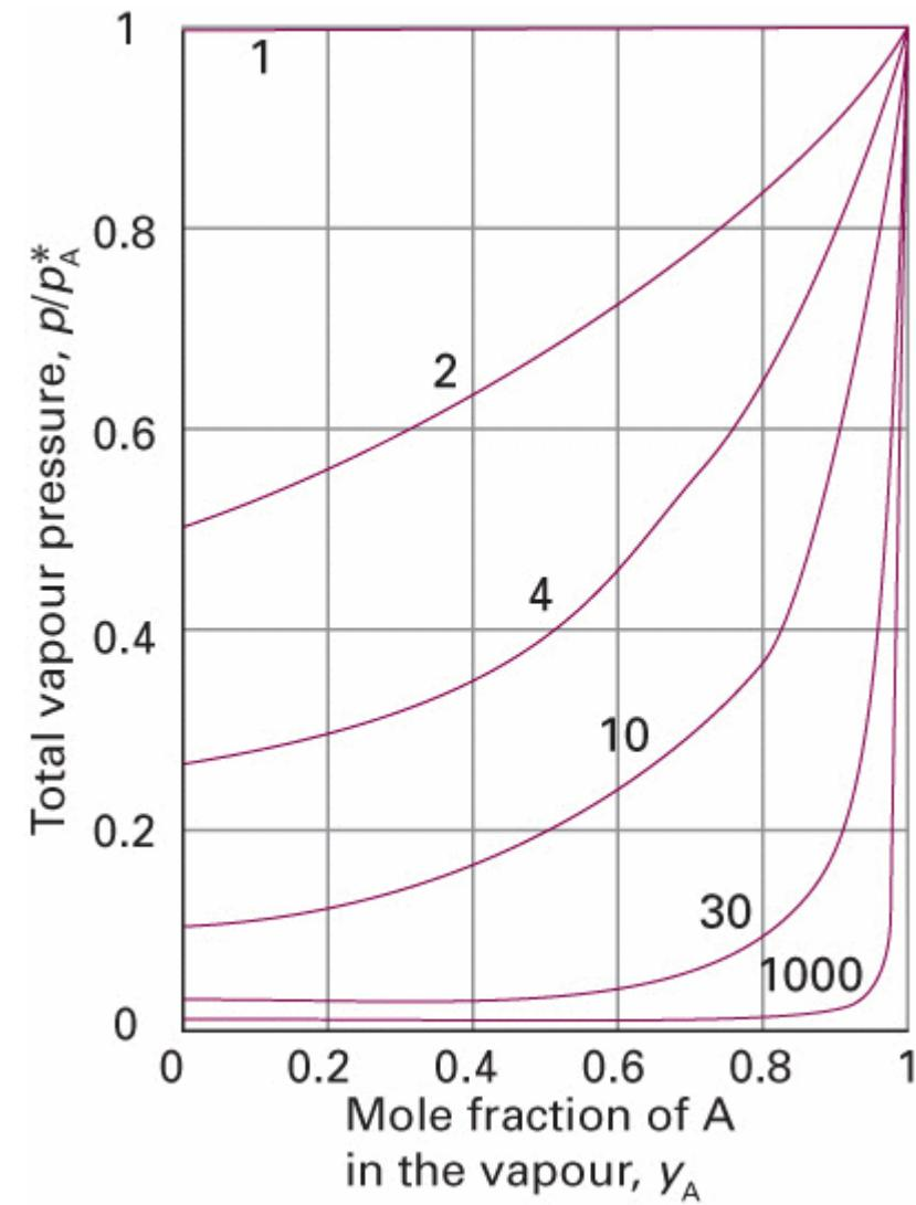
Der Dampfdruck des gleichen Systems wie in der vorherigen Abb., hier jedoch aufgetragen gegen den Molenbruch von A im Dampf.
