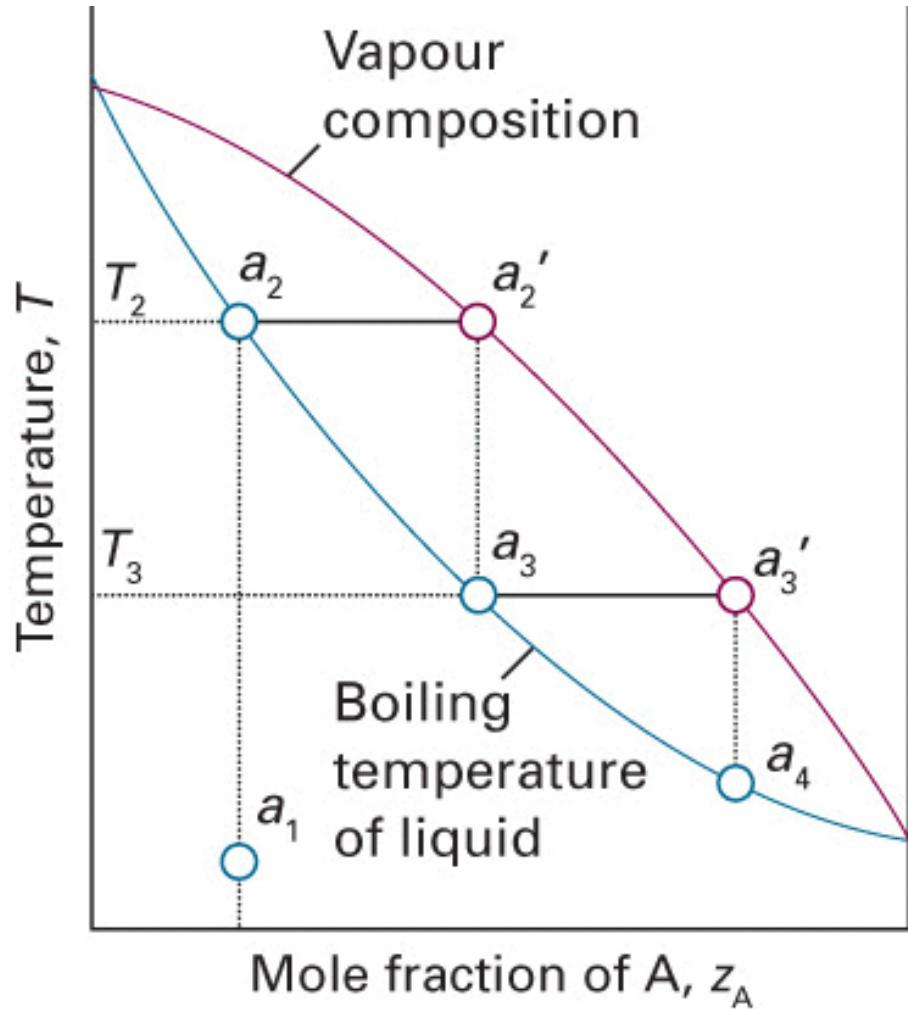
Siedediagramm einer idealen Mischung; Komponente A ist flüchtiger als Komponente B. Wird eine Mischung der Zusammensetzung  $a_1$  mehrmals erhitzt und wieder kondensiert, wird als Kondensat schließlich reines A erhalten.
