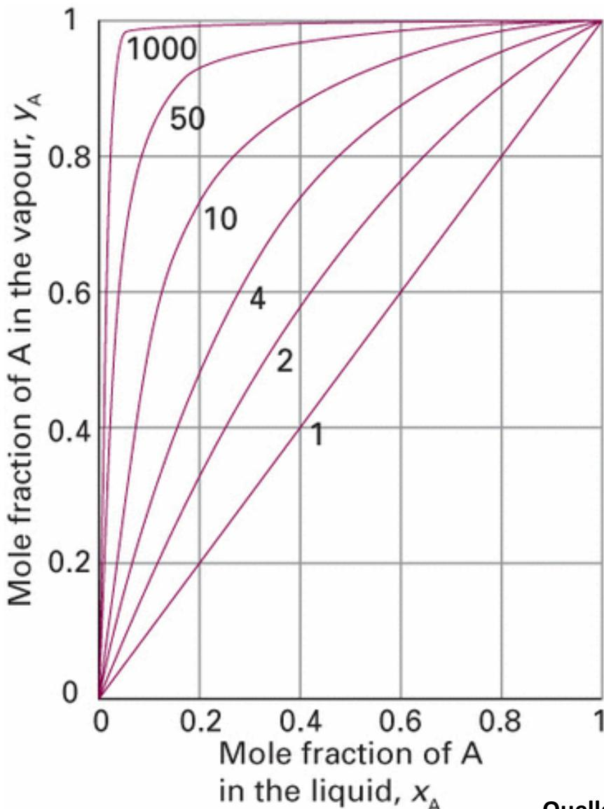
Der Molenbruch der Komponente A im Dampf einer binären idealen Mischung, aufgetragen gegen den Molenbruch von A in der flüssigen Phase. Für verschiedene Werte von  $p_A^0 / p_B^0$  (damit sind die Kurven beschriftet).
