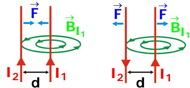
→ *Kraft wirkt auch innerhalb eines ausgedehnten Leiters und kann bei hohen Strömen zu Deformationen führen*
