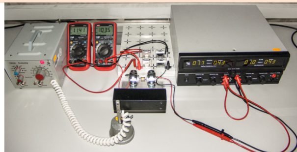
Abb. oben: Aufbau eines Netzwerkes mit einer Motor-Generator Kombination. Unten rechts: Linke Seite Motor Einspeisung, rechte Generator. Dazwischen liegt die Kupplung mit einer Messmarke.
