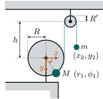
Nehmen Sie an, dass  $m$  sich nur in Richtung der Gravitationskraft bewegen kann, dass  $M > m$  und, dass das Seil lang genug ist, damit  $m$  niemals über die Rolle gezogen wird.
