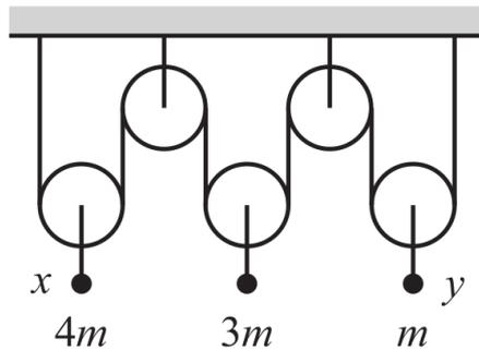
Die 3 Massen (von links nach rechts) sind  $4m$ ,  $3m$  und  $m$ . Es wirkt eine Gravitationskraft mit Gravitationsbeschleunigung  $g$  auf alle Masse. Die Bewegung der Massen erfolgt nur entlang der Richtung der Gravitationskraft. Die Rollen und Seile der Maschine können als masselos angenommen werden.
